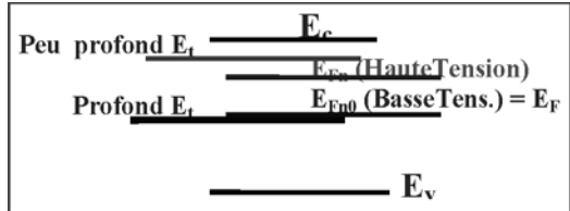
Figure 5.13 : repérage des niveaux d'énergie pour les pièges peu profonds et profonds
