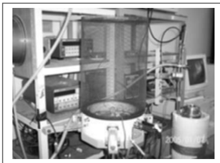
Figure 7.61. Banc de mesure de l'effet Seebeck.
