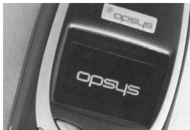
Figure 9.51. Écran OLED pour téléphone portable.
