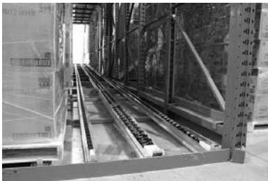
Le rayonnage à palettes ( pallet flow )
