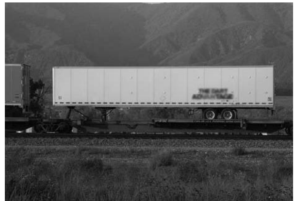
Le ferroutage consiste à mettre la semi-remorque sur un wagon plat.
