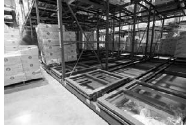
Le rayonnage à gravité ( push-back )
