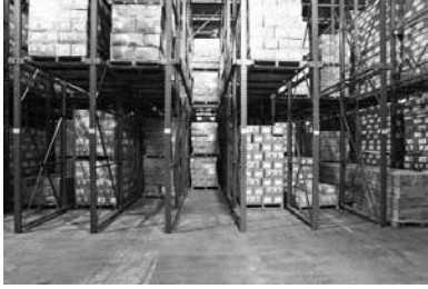
Le rayonnage à accumulation ( drive-in )
