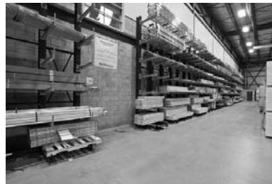
Le rayonnage en porte-à-faux ( cantilever )
