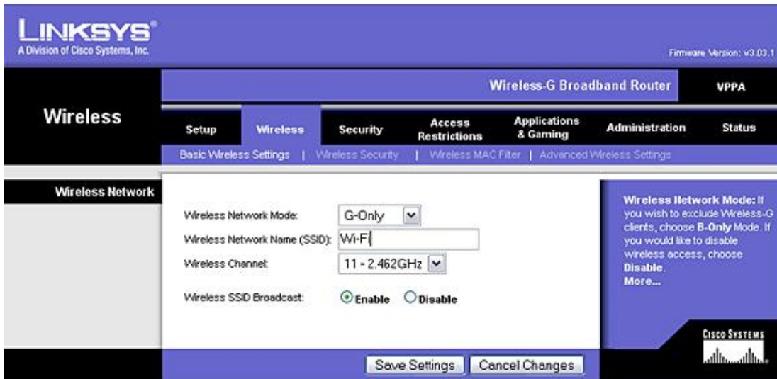
Écran de configuration des paramètres radio d'un point d'accès de marque Linksys
