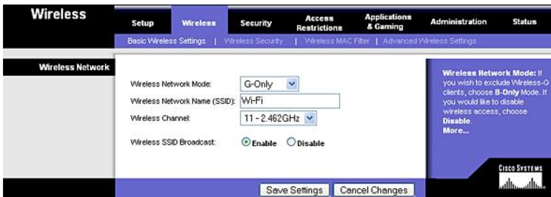
Exemple de champ de saisie de SSID et de choix de sa diffusion, sur un point d'accès de marque Linksys
