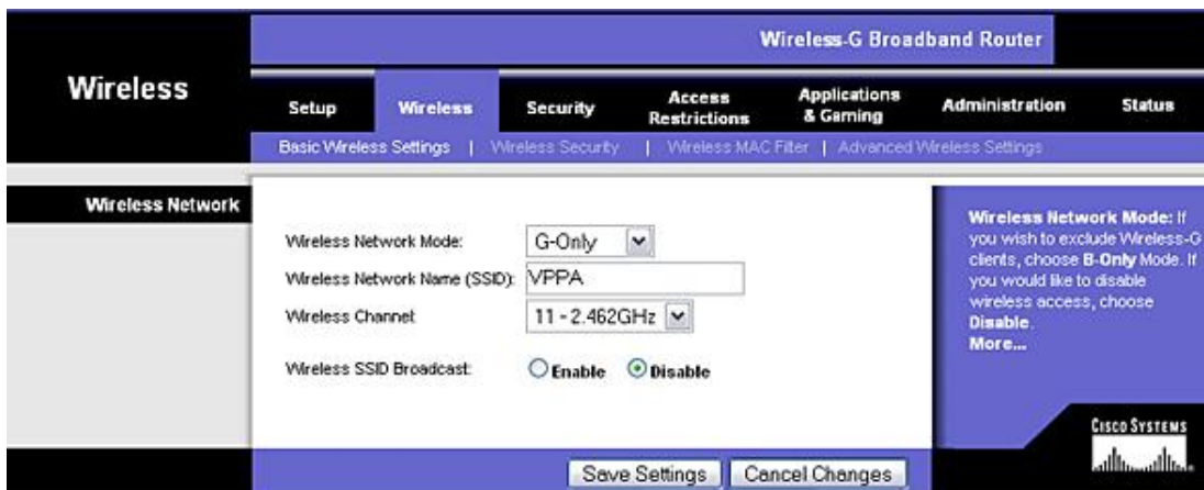
Exemple de configuration simple des paramètres radio
