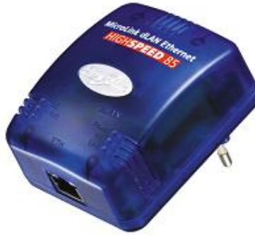
Interface réseau CPL à brancher sur prise électrique
