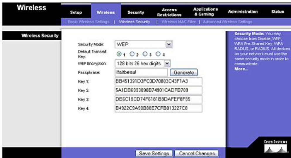
Génération automatique de clé à partir d'une phrase (passphrase), sur un point d'accès de marque Linksys
